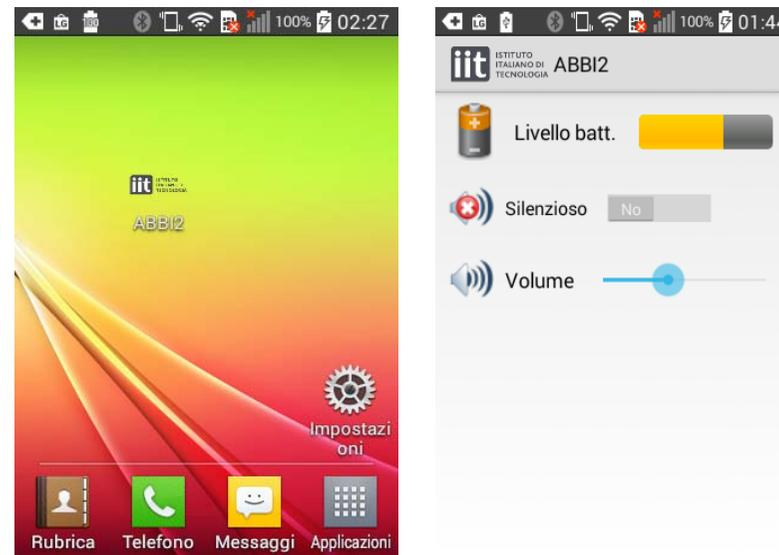
L'applicazione Android ABBI2 permette di conoscere il livello della batteria, alzare od abbassare il volume o rendere ABBI silenzioso.
